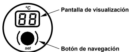
Pulsando sucesivamente el botón de navegación se irán seleccionando las distintas temperaturas a visualizar. Una vez seleccionada la temperatura deseada, transcurridos tres segundos, se visualizará la misma en la pantalla (en °C).
