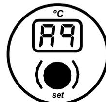
Se produce por cualquier anomalía que pudiera existir en el quemador o en la instalación de combustible. Para desbloquear, pulsar el pulsador luminoso que se enciende en el quemador.
