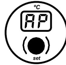
Se produce este bloqueo cuando la presión de la instalación baja por debajo de 0,5 bar, evitando que la caldera funcione cuando se vacía de agua la instalación, bien por tener alguna fuga o por operaciones de mantenimiento. Para desbloquear la caldera, se deberá llenar de nuevo la instalación, hasta que el manómetro **(15)** indique entre 1 y 1,5 bar.
