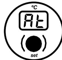
Se producirá siempre que la caldera sobrepase los 110 °C de temperatura. Para desbloquear se deberá pulsar el botón incorporado en el termostato de seguridad **(21)** después de haber soltado primeramente el tapón que tapa este botón.
