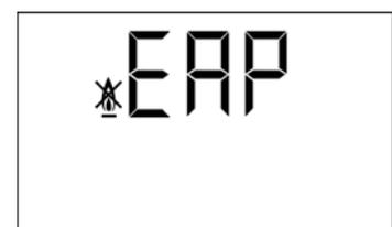
Se produce cuando la presión de la caldera baja por debajo de 0,5 bar, evitando que ésta funcione cuando se vacía de agua la instalación, bien por tener alguna fuga o por operaciones de mantenimiento. Para desbloquear, se deberá llenar de nuevo la instalación, hasta que en el parámetro de *"presión de la caldera"* del display **(18)** se visualice una presión entre 1 y 1,5 bar.
