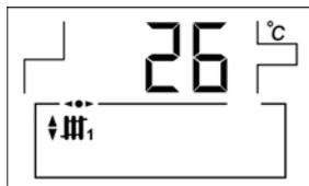
Temperatura real de ida de la instalación de Suelo Radiante. (sólo en opción SRFC2/EV)
