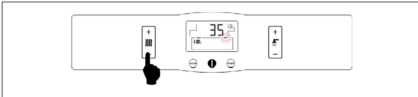
Cuando la caldera es instalada con el Kit opcional de Suelo Radiante SRFC2/EV, la selección de la temperatura deseada de funcionamiento de de ida de la instalación se realiza mediante el selector táctil indicado en la figura. Para seleccionar la temperatura deseada tocar en los símbolos "+" o "-" para incrementar o disminuir el valor de la temperatura, respectivamente. Una vez seleccionada la temperatura, en unos pocos segundos la pantalla regresará a la situación de reposo.
