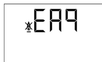
Se produce por cualquier anomalía que pudiera existir en el quemador **(10)** o en la instalación de combustible. Para desbloquear, pulsar el pulsador luminoso que se enciende en el quemador.
