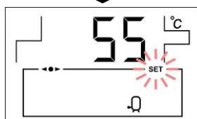
Consigna de temperatura de A.C.S. seleccionada mediante el selector táctil correspondiente **(24)**.
