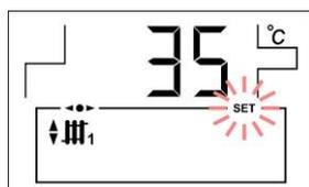
Consigna de temperatura de ida de la instalación de Suelo Radiante seleccionada mediante el selector táctil correspondiente **(20)**.
