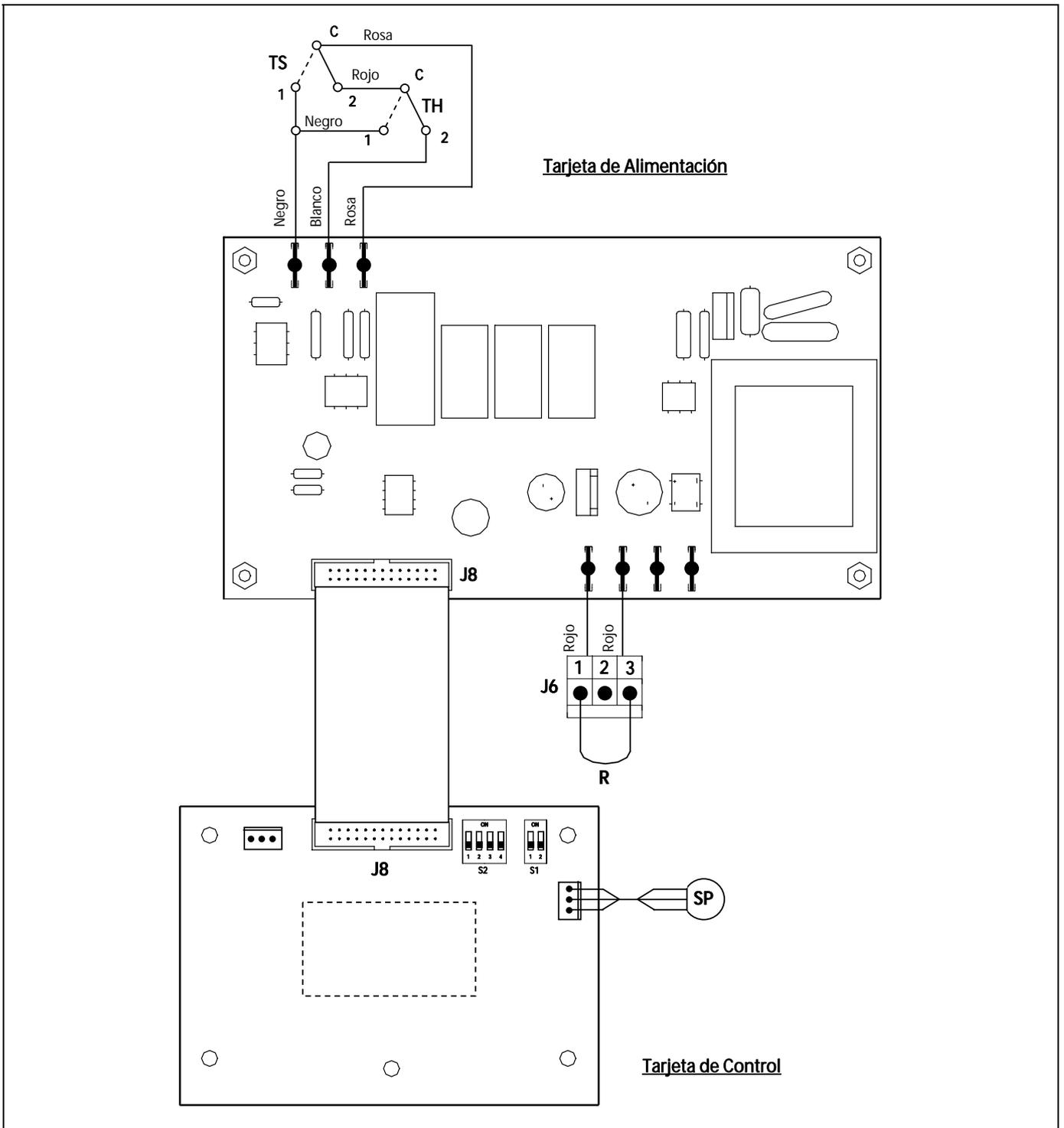
**TS:** Termostato de Seguridad.
