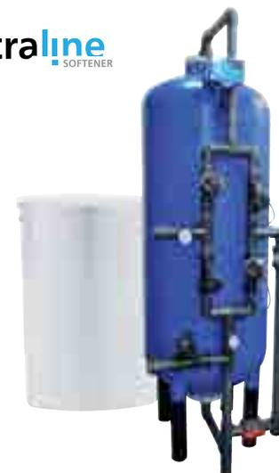
Equipos compuestos de botella de PRFV o poliamida con distribuidores superior e inferior y depósito de sal en polietileno. Batería de válvulas de diafragma automáticas, controladas mediante distribuidor hidráulico con programador electrónico. Contador con emisor de impulsos independiente.
