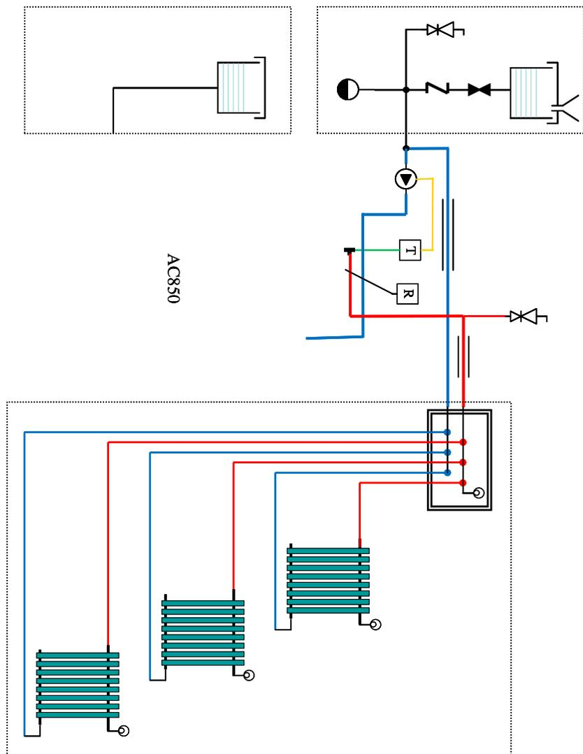
**Ilustración 2** Esquema de instalación para calefacción central (AC) y calentamiento de agua doméstica (AD) con acumulador y dos bombas de circulación (recomendado).
