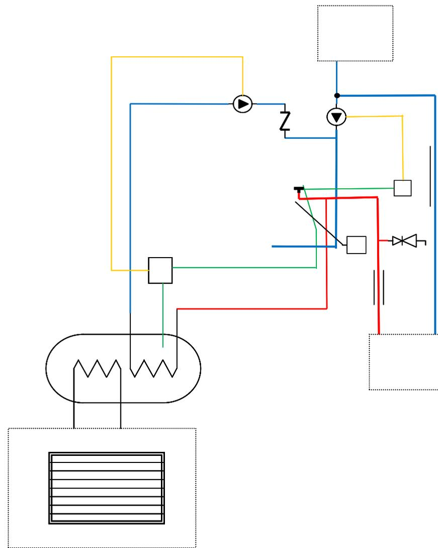
**Ilustración 3** Esquema de instalación para calefacción central (AC) y calentamiento de agua doméstica (AD) con acumulador y una bomba de circulación
