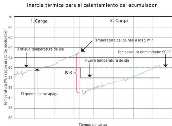
Este sistema hace que se alcance exactamente la temperatura deseada en el acumulador, desconectando la carga un tiempo antes de haber finalizado. La diferencia entre la temperatura de desconexión y el valor de consigna del acumulador depende del diseño de la instalación. Por ello, después de cada reseteo y apagado/encendido, se calcula un valor de consigna optimizado durante las primeras 5 cargas del acumulador.
