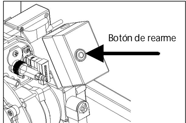
El LED multicolor del botón de rearme es el elemento indicador para el diagnóstico visual. Tanto el pulsador como el LED se ubican bajo la cubierta transparente del botón de rearme. En funcionamiento normal, los distintos estados de funcionamiento se indican en forma de códigos de color (consultar la tabla de códigos de color de abajo). Durante el arranque, la indicación tiene lugar según la siguiente tabla:
