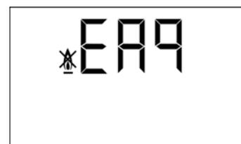
Se produce por cualquier anomalía que pudiera existir en el quemador **(2)** o en la instalación de combustible. Para desbloquear, pulsar el pulsador luminoso que se enciende en el quemador.
