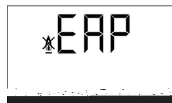
Se produce cuando la presión de la caldera baja por debajo de 0,5 bar, evitando que ésta funcione cuando se vacía de agua la instalación, bien por tener alguna fuga o por operaciones de mantenimiento. Para desbloquear, se deberá llenar de nuevo la instalación, hasta que en el parámetro de *"presión de la caldera"* del display **(11)** se visualice una presión entre 1 y 1,5 bar.
