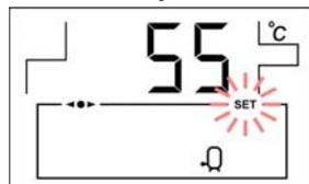
Consigna de temperatura de A.C.S. seleccionada mediante el selector táctil correspondiente **(16)** (con interacumulador).
