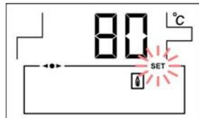
Consigna de temperatura de caldera seleccionada mediante el selector táctil correspondiente **(12)**.
