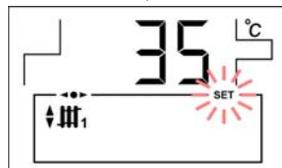
Consigna de temperatura de ida de la instalación de Suelo Radiante seleccionada mediante el selector táctil correspondiente **(12)**. (sólo en opción SRAC2/EV)
