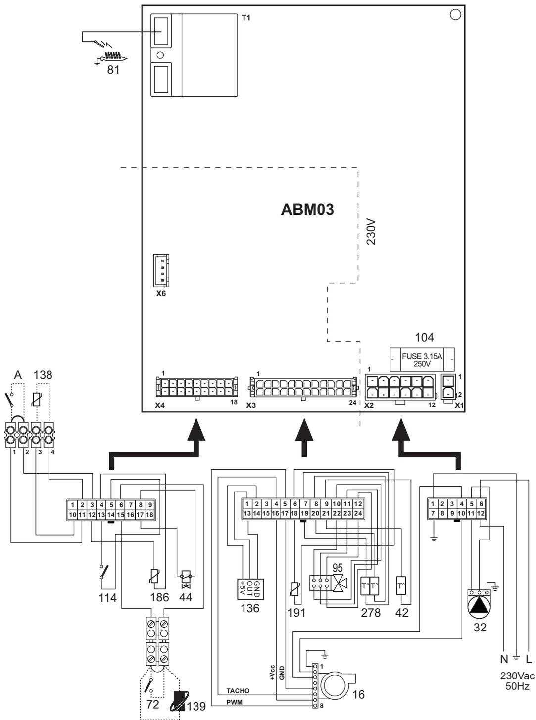
fig. 30 - Esquema eléctrico
