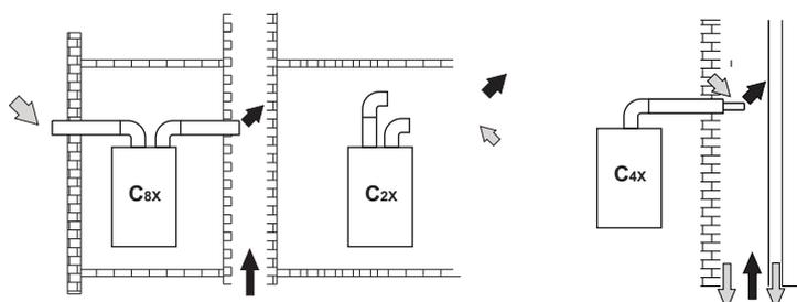
fig. 19 - Ejemplos de conexión a chimeneas ( = aire / = humos)
