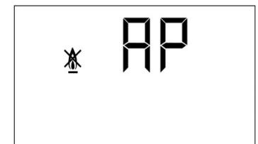
Se produce cuando la presión de la caldera baja por debajo de 0,5 bar, evitando que ésta funcione cuando se vacía de agua la instalación, bien por tener alguna fuga o por operaciones de mantenimiento. Para desbloquear, se deberá llenar de nuevo la instalación, hasta que en el parámetro de "presión de la caldera" del display (19) se visualice una presión entre 1 y 1,5 bar.
