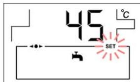
Consigna de temperatura de A.C.S. seleccionada mediante el selector táctil correspondiente (24).
