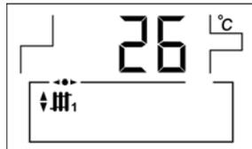
Temperatura real de ida de la instalación de Suelo Radiante.
