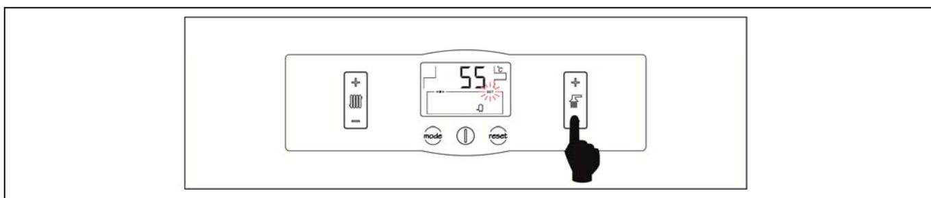
La selección de la temperatura de A.C.S. deseada se realiza mediante el selector táctil indicado en la figura. Para seleccionar la temperatura deseada tocar en los símbolos "+" o "-" para incrementar o disminuir el valor de la temperatura, respectivamente. Una vez seleccionada la temperatura, en unos pocos segundos la pantalla regresará a la situación de reposo. El rango de temperatura de consigna de A.C.S. seleccionable es de OFF, 30 - 65 °C.
