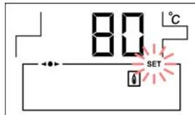
Consigna de temperatura de caldera seleccionada mediante el selector táctil correspondiente(20).
