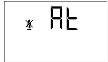
Se producirá siempre que la caldera o los humos sobrepasen los 110 °C de temperatura. Para desbloquear, se deberá esperar a que la temperatura baje de 100 °C y se deberá pulsar el botón incorporado en el termostato de seguridad o termostato de seguridad de humos, situados en el interior de la caldera en la parte inferior del cajón eléctrico.
