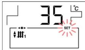
Consigna de temperatura de ida de la instalación de Suelo Radiante seleccionada mediante el selector táctil correspondiente(20).
