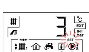
Contraste de la pantalla deseado, ajustado mediante selector táctil de la parte derecha del display (24).
