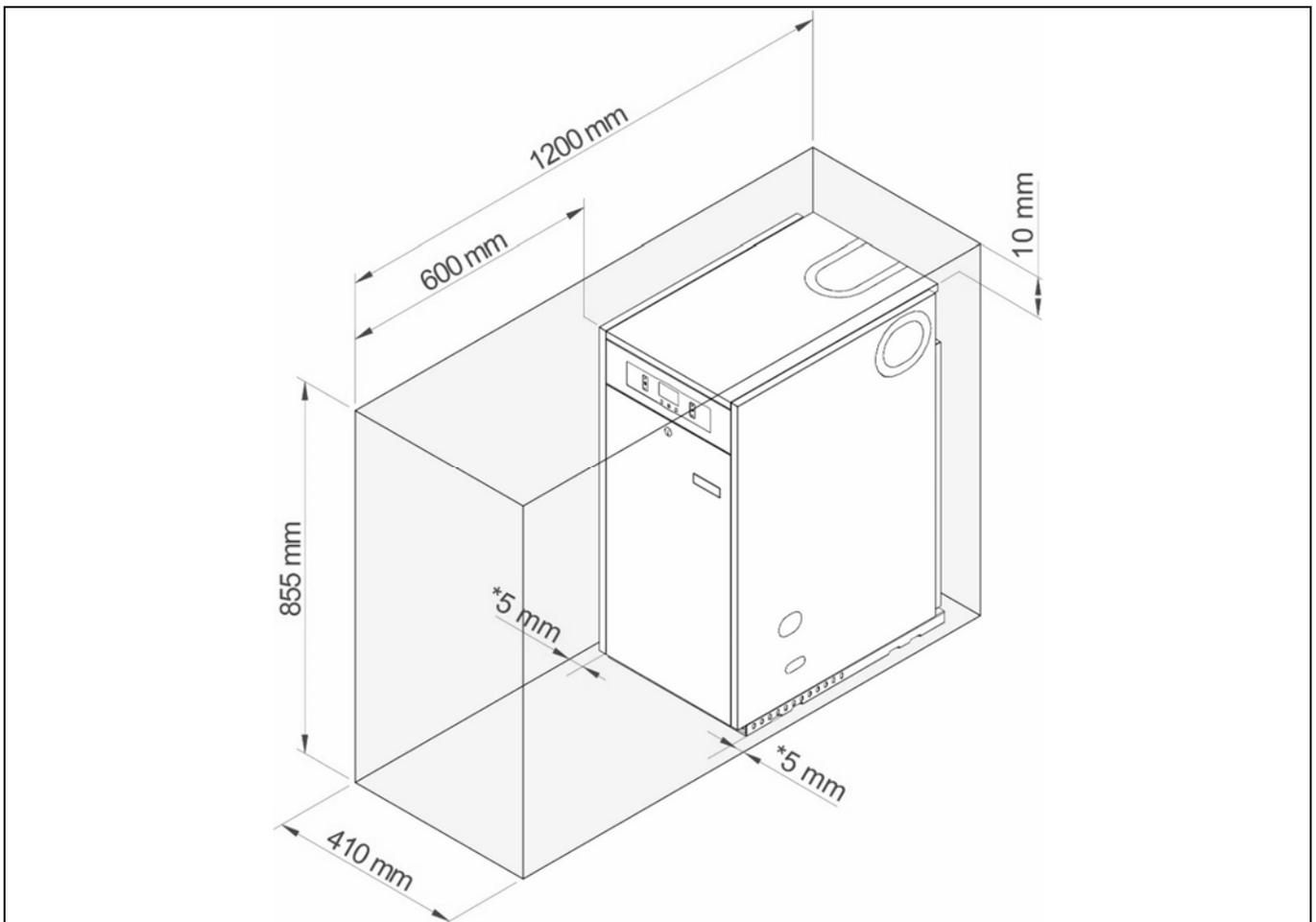
La caldera es apta para ser instalada debajo de una encimera, teniendo en cuenta las distancias mínimas para operaciones de mantenimiento citadas. Se debe prever que dicha encimera sea desmontable para poder efectuar operaciones de asistencia técnica y reparación.
