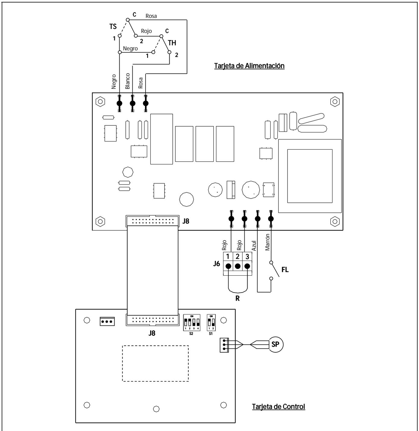
**TS:** Termostato de Seguridad.
