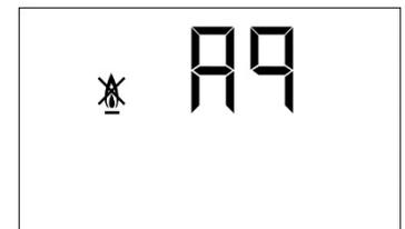
Se produce por cualquier anomalía que pudiera existir en el quemador (2) o en la instalación de combustible. Para desbloquear, pulsar el pulsador luminoso que se enciende en el quemador.
